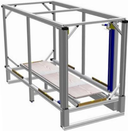
Die STEP-FOUR PC-CUT 2500 ist eine computergesteuerte 4-Achs-Heizdrahtschneideanlage. Mit ihr werden Objekte jeglicher Art aus expandiertem oder extrudiertem Polystyrolschaum geschnitten. Das Raumgewicht des Rohmaterials muss zwischen  $15\text{kg/m}^3$  und  $50\text{kg/m}^3$  liegen. Die computerunterstützte Bearbeitung garantiert dabei absolute Präzision und Reproduzierbarkeit.
